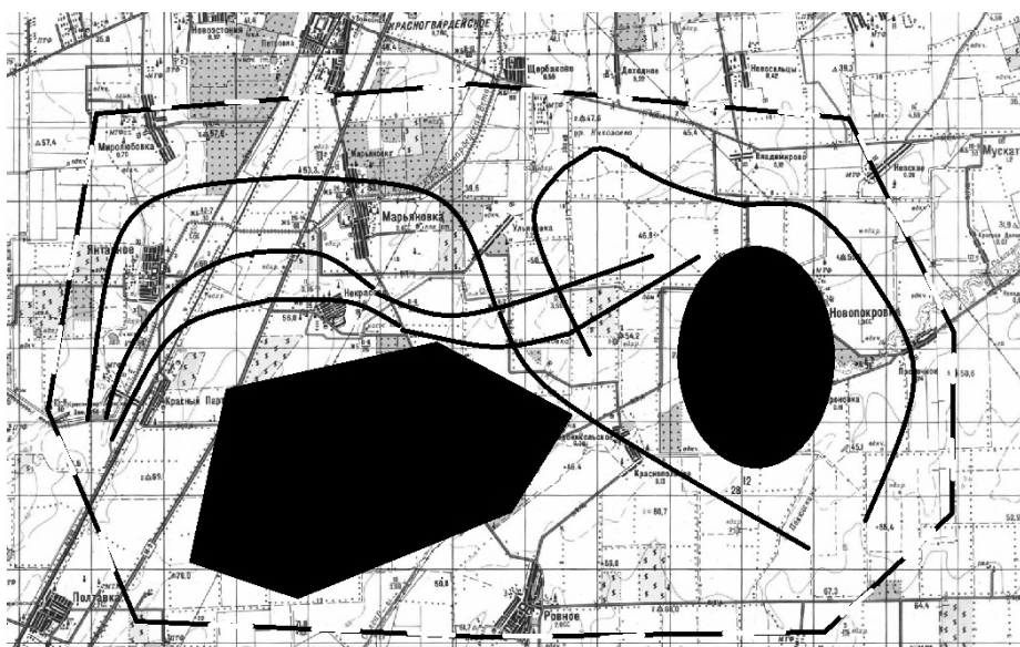
Рис. 7. Можливі траси, побудовані за допомогою траєкторій Дьубинса (чорним кольором показано дві зони, в яких політ заборонено)
