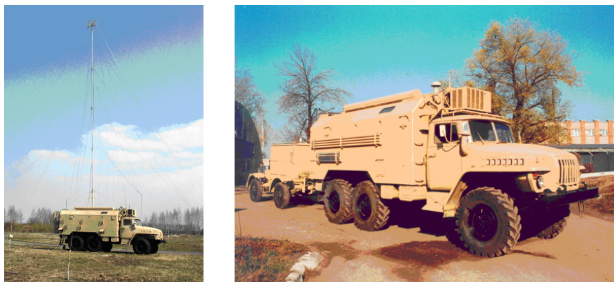
Рис. 3. Автоматизована станція перешкод УКХ радіозв'язку Р-330Т: а – висота підйому щогли – 20 м; б – габаритні розміри 8600х2600х3845 мм
