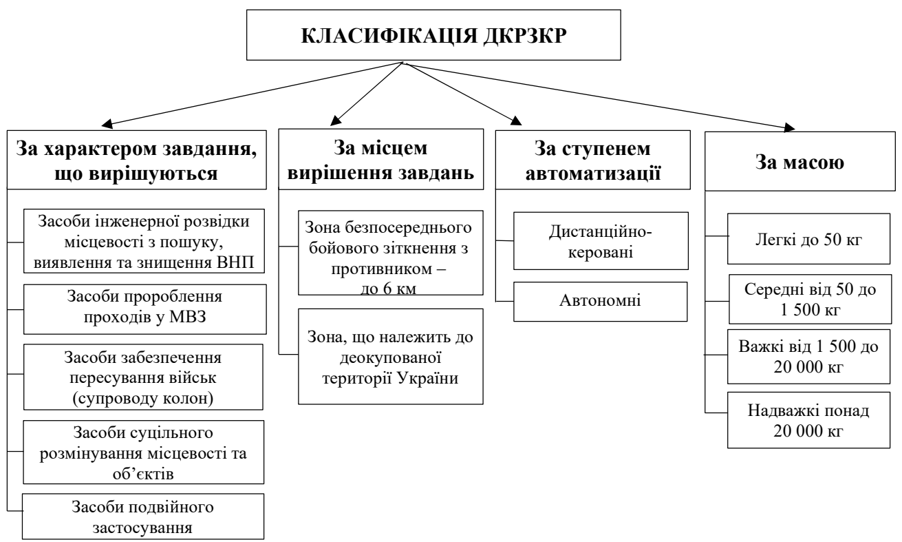
Рисунок 2 – Класифікація дистанційно-керованих (роботизованих) засобів (комплексів) розмінування фасетним методом
