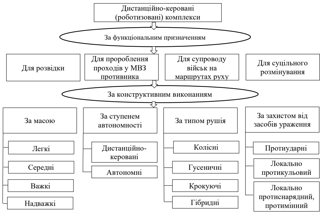
Рисунок 1 – Класифікація дистанційно-керованих (роботизованих) засобів (комплексів) розмінування ієрархічним методом
