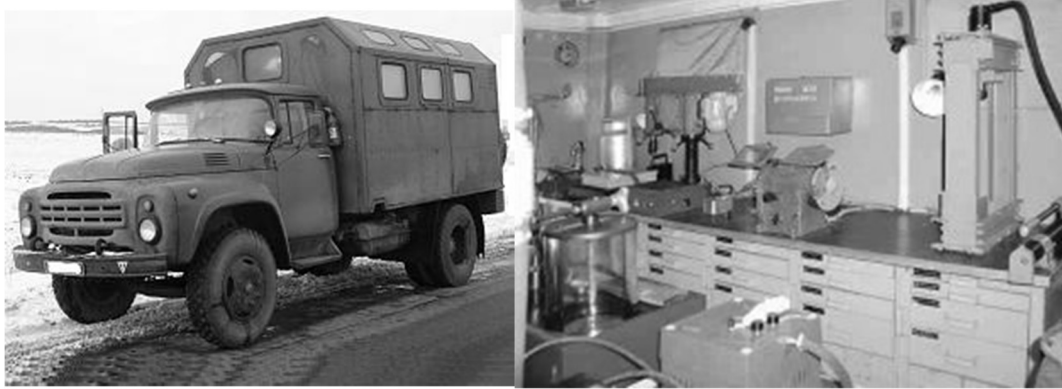
Рисунок 3 – Майстерня ремонту холодильного і технологічного обладнання МРХТО-53
