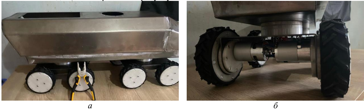
Рисунок 5 – Натурна масштабна модель чотиривісної броньованої колісної машини з двома поворотними платформами: а – загальний вигляд моделі БКМ; б – вигляд поворотної платформи
